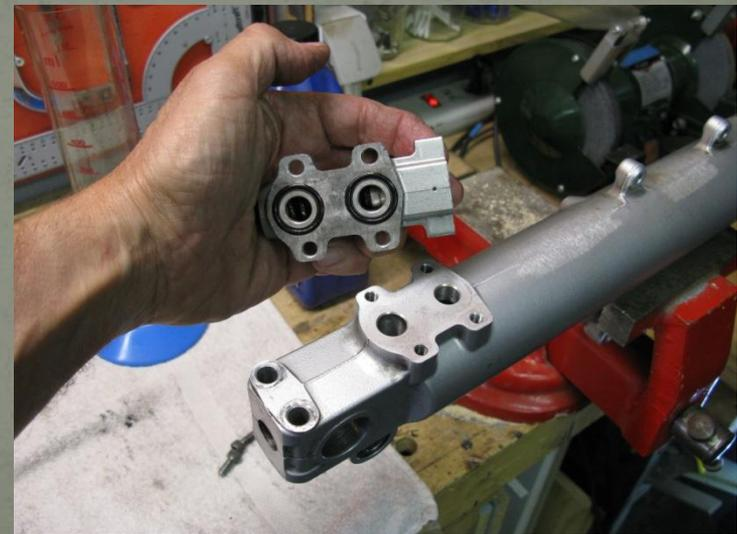
Replacer le **piston anti-plongée**. Bien positionner les **joints torique**
