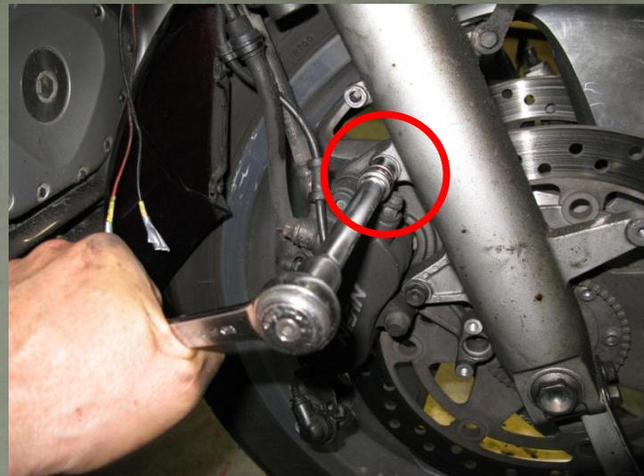
Dévisser les vis 3 vis de fixation de l'ensemble de l'étrier droit.
