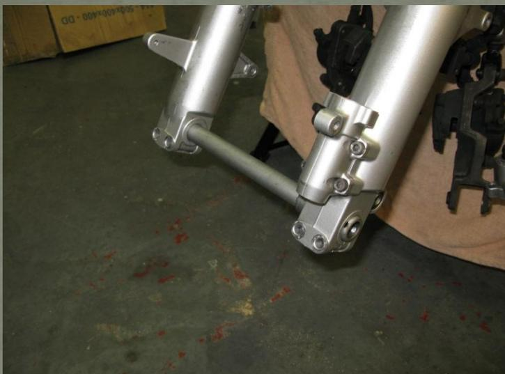
J'ai mis l'axe de roue avant de serrer les bribes supérieures et inférieures
