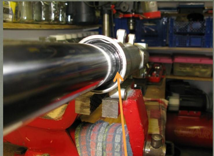
Déposer de la bague d'arrêt dans la glissière de fourche
