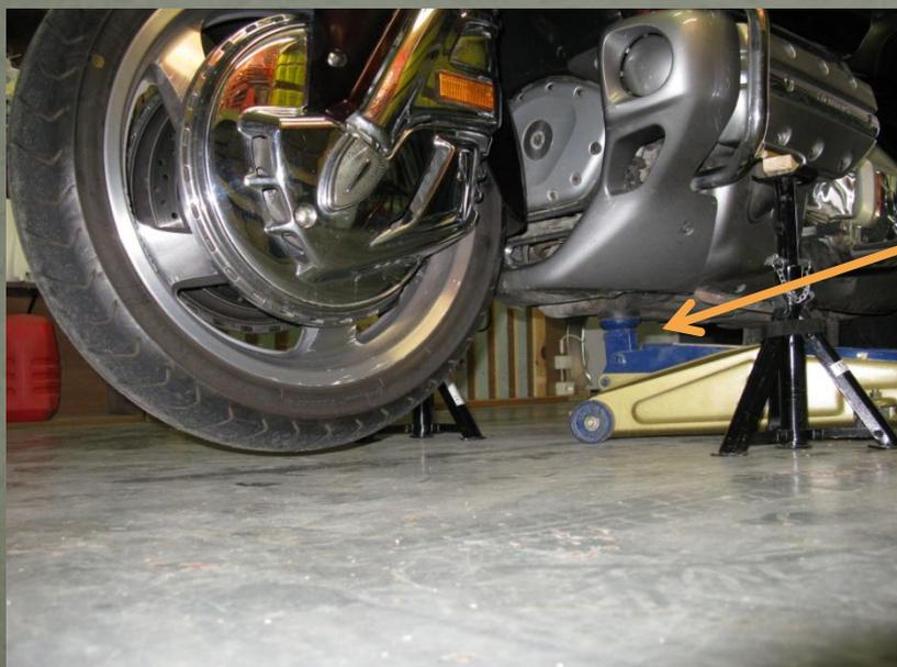
Je peux soulever l'avant de la moto en mettant un petit cric hydraulique sous le moteur et je stabilise avec les deux chandelles.
