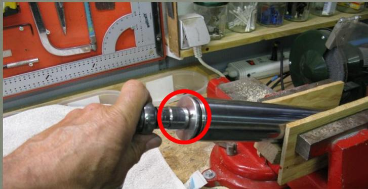
Déposer le capuchon de fourche (au préalable desserrer sur la moto. Sinon avec une clé à chocs ça marche aussi). Attention à son joint torique et au ressort derrière (retenir avec la main)
