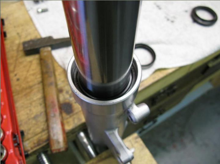
La bague d'arrêt d'huile en buté dans son logement la gorge de la bague d'arrêt doit être visible
