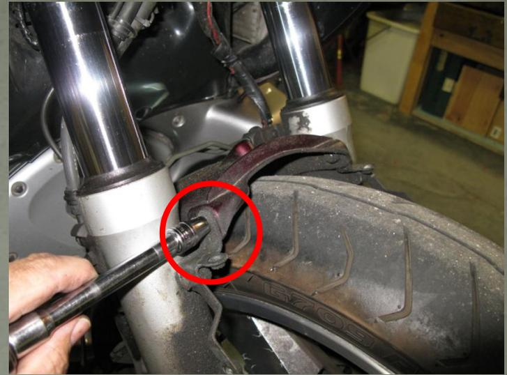
Dévisser les 2 vis avant de la partie arrière du garde boue
