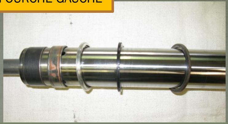
Replacer sur le tube de fourche, la douille de guidage, les bagues d'appui (chanfrein vers le bas), la bague d'arrêt d'huile (mettre un peu de liquide de fourche sur la lèvre)
