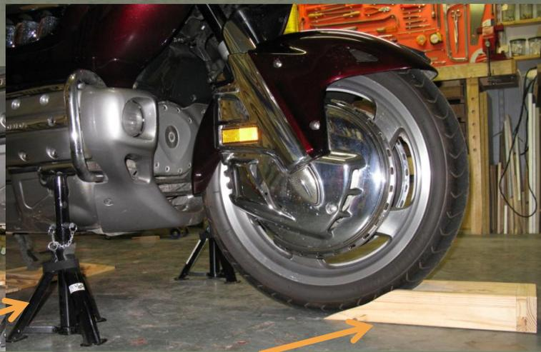
Une cale sur la roue avant pour éviter que la moto avance pendant la manœuvre.
