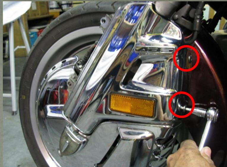
Déposer la partie avant du garde boue et des chromes
