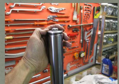
Remettre le **ressort de fourche** (spires serrées vers le bas) , le **siège du ressort**, l'**entretoise**, le **capuchon de fourche** (mettre un peu de liquide de fourche sur le joint torique). Serrez le capuchon de fourche après avoir installé le tube de fourche dans les brides de fourche.
