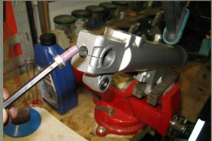
Mettre la **rondelle d'étanchéité** et du **frein filet** (faible) sur le filetage du **boulon central de fourche**.
