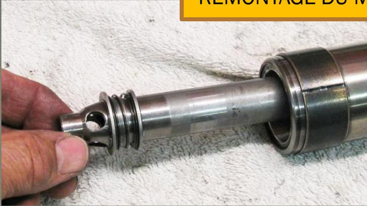
Replacer sur le piston de fourche, le siège du ressort, le ressort, la valve de blocage d'huile, la bague d'arrêt.
