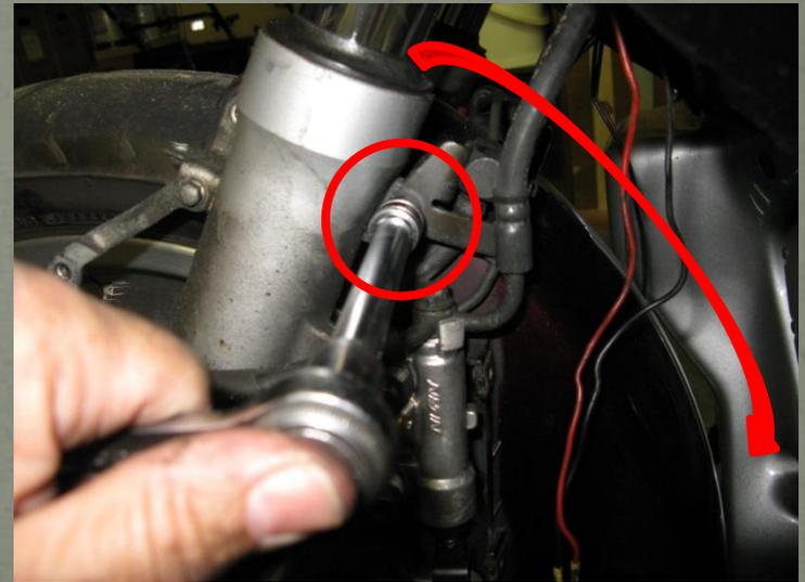
Dévisser les 2 vis arrière (longueur différente) de la partie arrière du garde boue.
