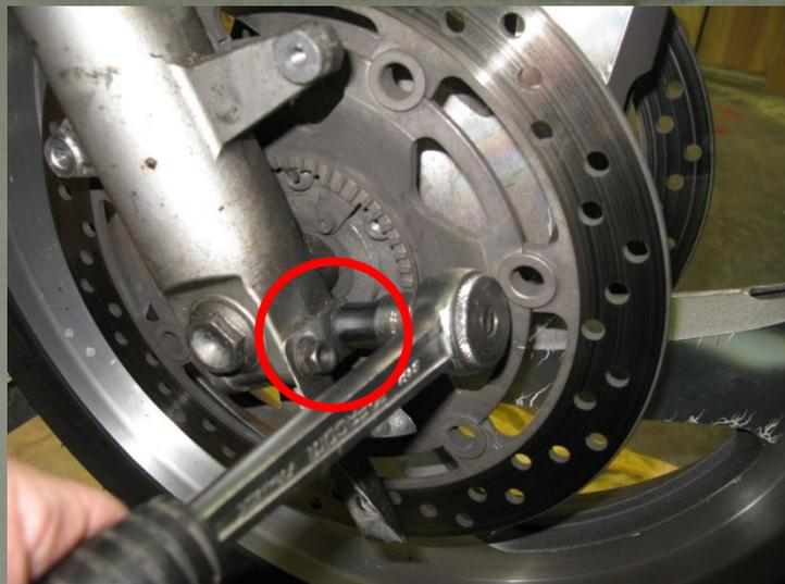
Dévisser les 4 vis des brides des tubes. Déposer les supports des chromes.
