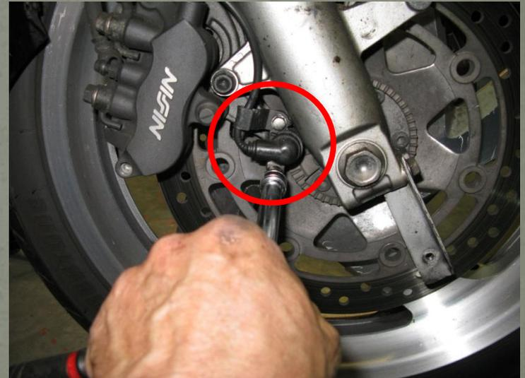
Déposer le capteur de vitesse
