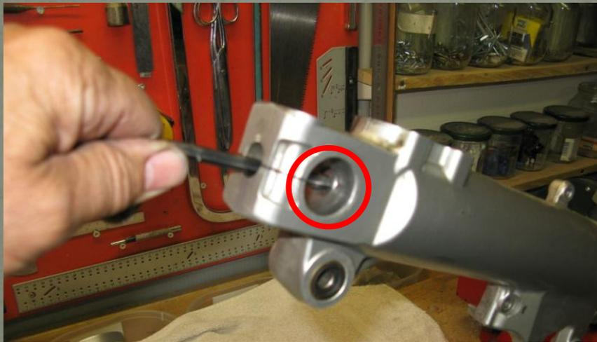
Dévisser le **boulon centrale de fourche** et son joint. Mettre le **montant** dans un récipient. Appuyer et pomper doucement pour le vidanger
