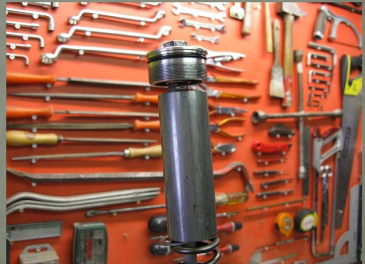
Remettre le **ressort de fourche** (spires serrées vers le bas) , le **siège du ressort**, l'**entretoise**, le **capuchon de fourche** (mettre un peu de liquide de fourche sur le joint torique). Immobiliser le **contre-écrou d'amortisseur de fourche** et serrez le **capuchon de fourche**.
