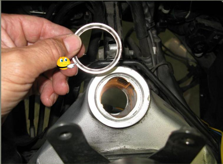
Extraire la cage du roulement sur la colonne de direction.
