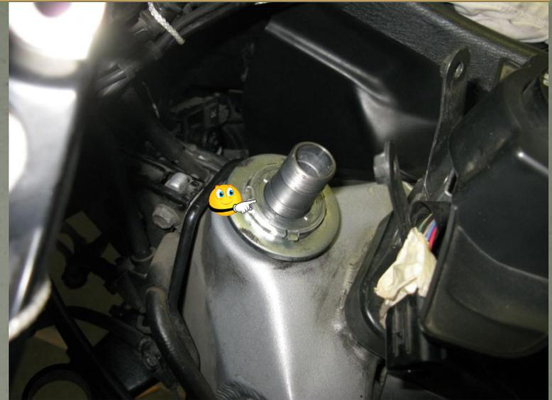
Mettre le contre-écrou, le serrer, relever les languettes de la rondelle frein
