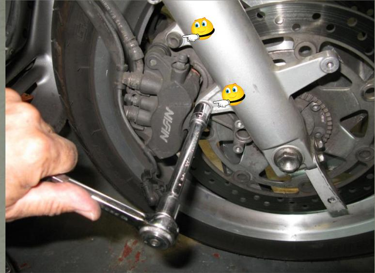
Déposer la seconde vis de la
