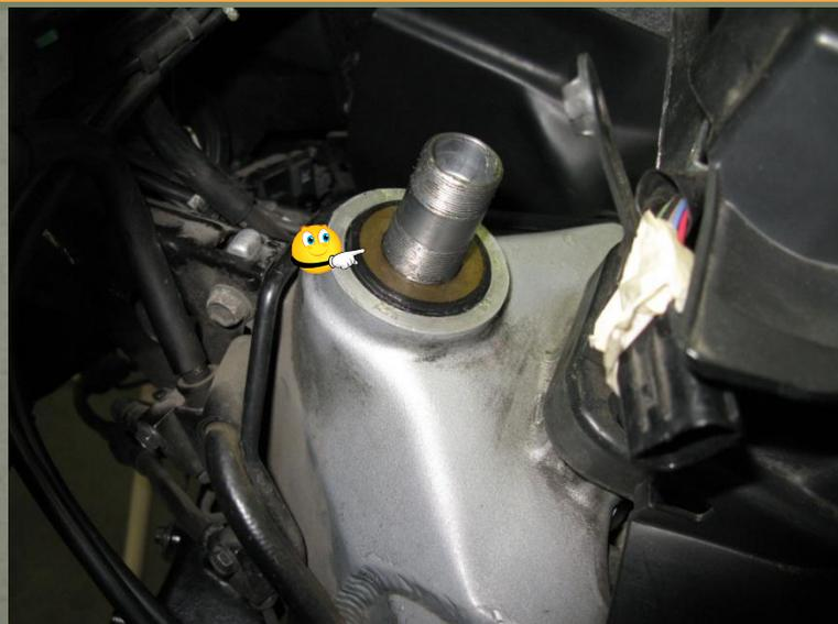
Régler l'écrou du serrage des roulements de la colonne, Mettre la rondelle frein
