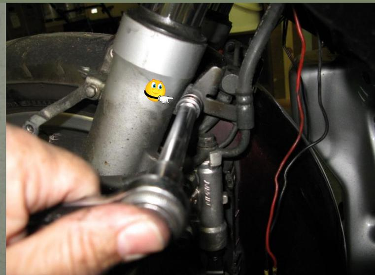
Appuyer sur l'aile pour la descendre sur le pneu et glisser vers l'arrière.
