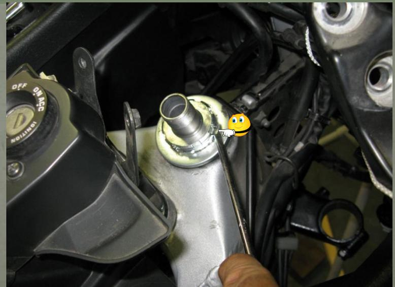
Mettre la bride supérieure de la colonne de direction, visser l'écrou sans serrer
