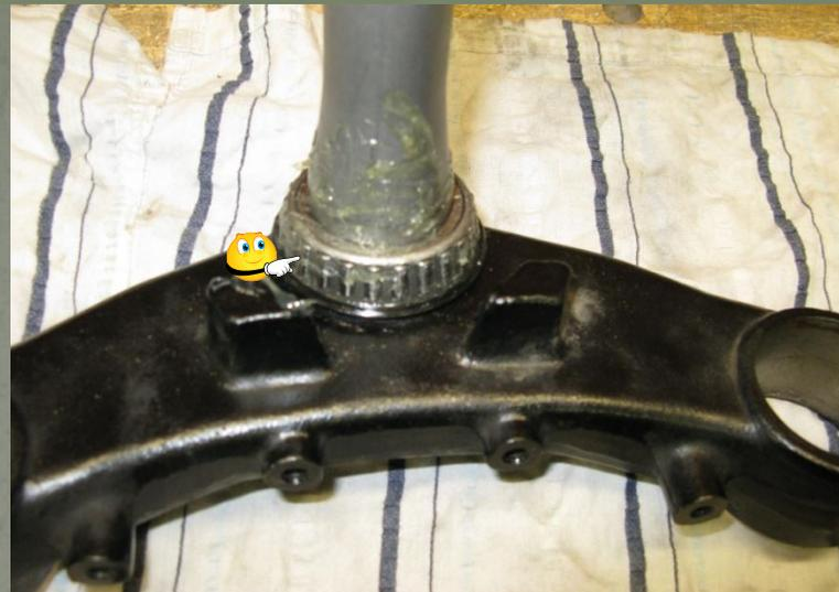
Mettre en place la colonne de direction, le roulement supérieur, le joint anti-poussière
