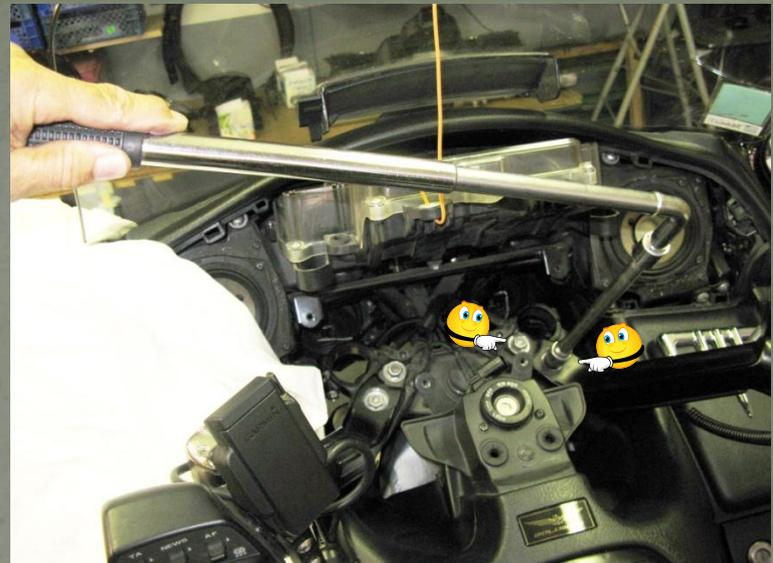
Protéger la carrosserie et attacher le plus verticalement possible les réservoirs d'embrayage et de frein
