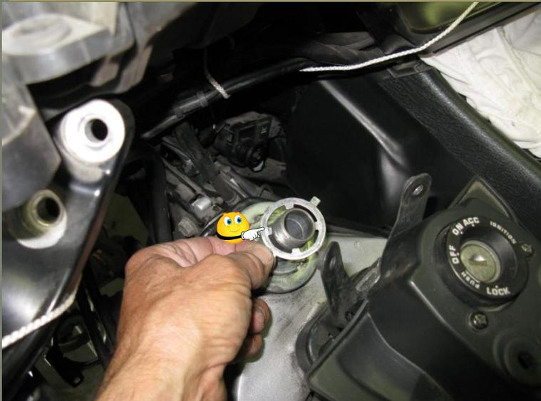
Enlever l'écrou de réglage de serrage des roulements
