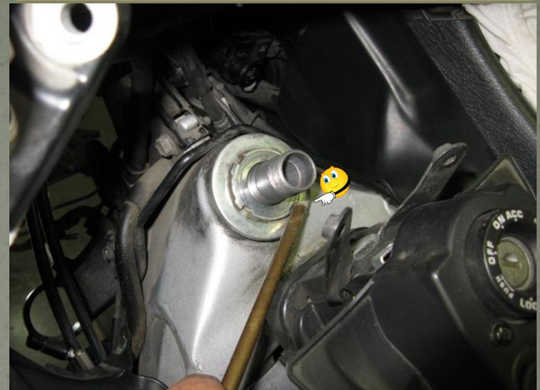
Desserrer l'écrou d'une main et retenir la bride inférieure de l'autre (on y arrive)
