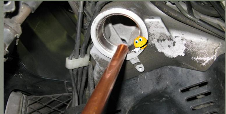
J'ai pris un tube de cuivre sur lequel j'ai scotché un bouchon de canalisation en laiton (côté large) pour d'abord bien positionner la cage du roulement sur son emplacement. Puis j'ai retourné le tube (côté étroit) pour terminer de le mettre en place bien au fond...
