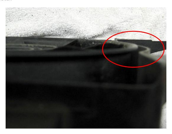
Lorsque le ventilateur est retourné, il est plus haut que le boîtier. S'il était remonté maintenant, il heurterait le radiateur. Le boîtier du ventilateur doit être calé pour l'éloigner du radiateur.
