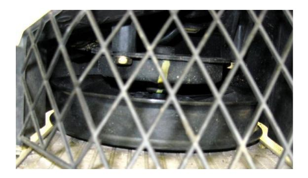
J'ai utilisé deux rondelles de 6.3 mm sur chaque patte de fixation pour retrouver le jeu nécessaire. Trois rondelles étaient trop grandes. J'ai fait tourner le ventilateur pour m'assurer qu'il ne se toucherait pas à vitesse élevée. Les boulons d'origine sont trop courts pour être utilisés avec les nouvelles cales. J'ai acheté de nouveaux boulons M6 x 1,0 x 1". Utilisez frein filet sur tous les boulons.
