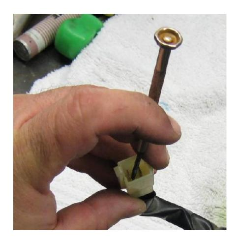
La dernière chose à modifier est le connecteur. Insérez un petit tournevis de bijoutier dans la languette pour libérer les fils et réinsérez-les à l'envers. Répétez l'opération pour l'autre ensemble radiateur/ventilateur. L'inversion des ventilateurs est en fait un projet assez simple. C'est l'accès aux ventilateurs qui prend du temps.
