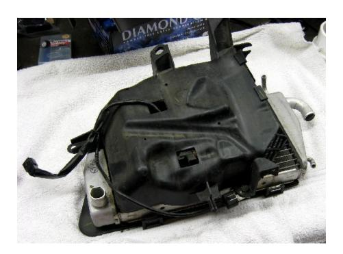
Voici l'ensemble ventilateur/radiateur gauche démonté. Il y a deux boulons qui le maintiennent en place et une languette dans laquelle il s'insère. J'ai testé l'installation pour m'assurer qu'elle fonctionnait et que quelqu'un ne l'avait pas déjà inversée. Le ventilateur produit beaucoup d'air.
