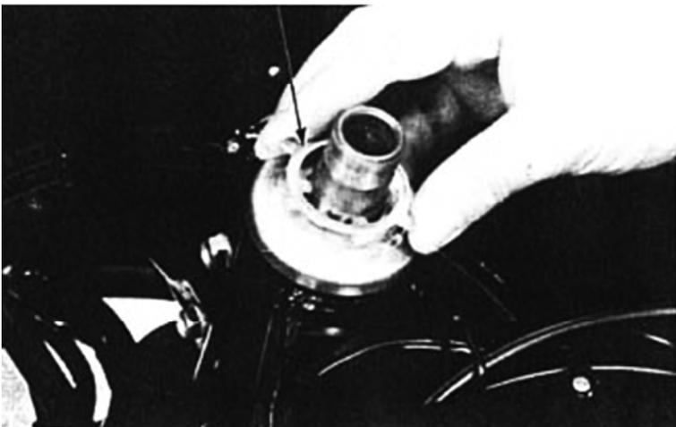
Maintenir l'écrou de réglage et serrer le contre-écrou à la main afin de faire coïncider ses gorges avec les languettes de la rondelle-frein.
