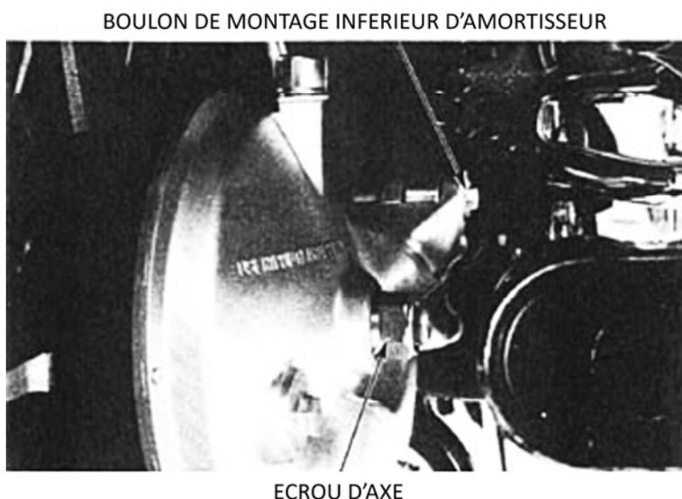
Reposer et serrer le boulon inférieur de l'amortisseur gauche.
