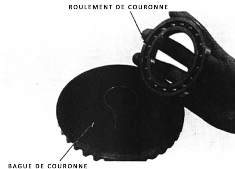
Mettre un roulement de couronne neuf en place sur l'arbre de couronne.
